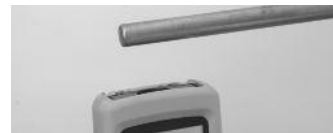
Бесконтактное (оптическое) измерение
