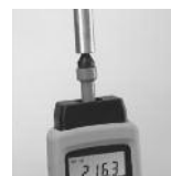
Механическое измерение с наконечн. зонда
