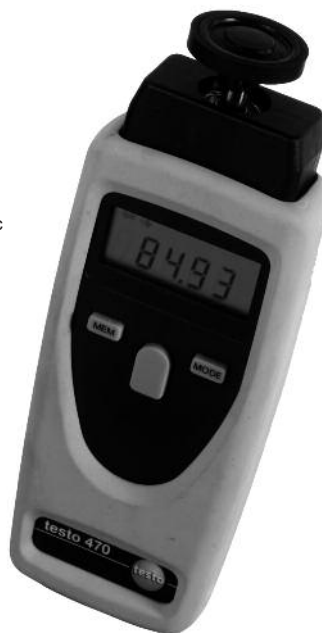
Механическое измерение с наконечн. зонда
